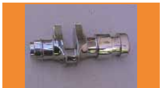
Figura 11 - Albero motore da competizione dopo la lucidatura
