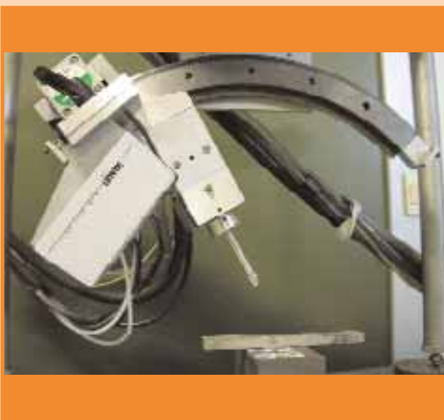
Figura 6 - Diffrattometro a raggi X che consente di apprezzare le differenze impresse nella "memoria" della superficie sottoposta a lucidatura
