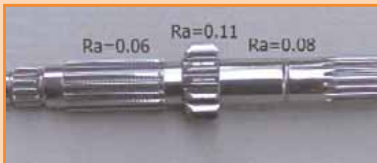
Figura 10 - Albero primario di cambio motociclistico trattato mediante vibrofinitura
