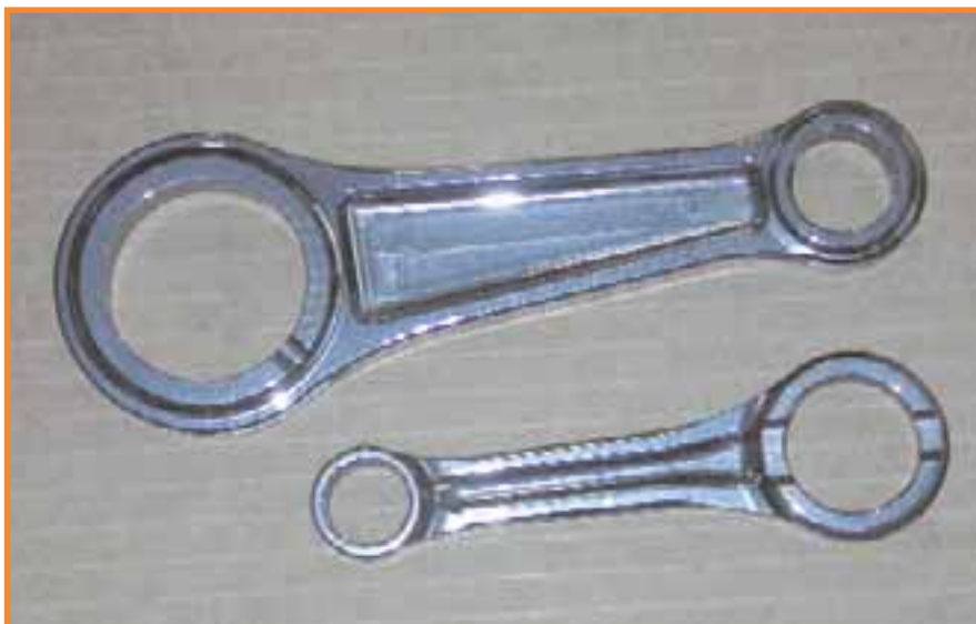
Figura 12 - Bielle per un motore di kart dopo trattamento di pallinatura e vibrofinitura
